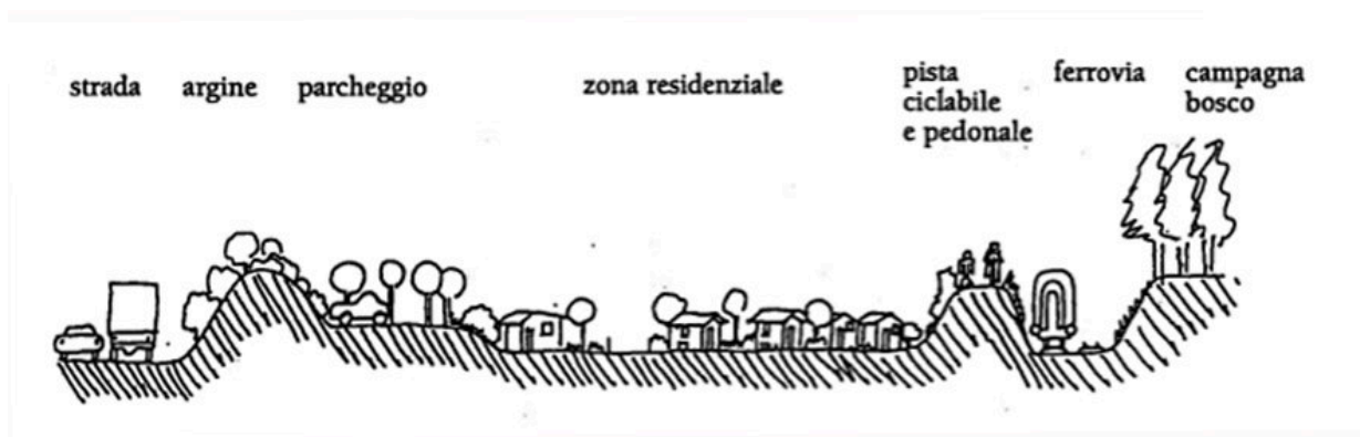
Sezione che indica gli accorgimenti per la protezione dell'inquinamento acustico e visivo di un nucleo residenziale
